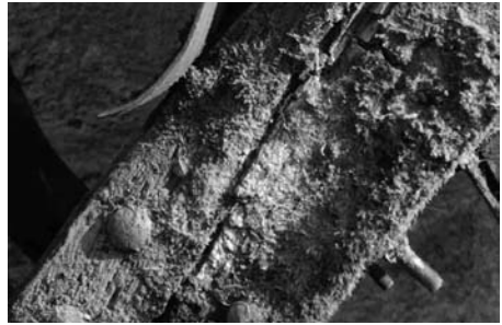
Die schädlichen Auswirkungen auf den hölzernen Radkranz sind deutlich zu erkennen
